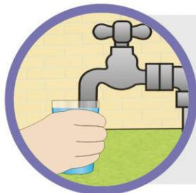
Feche o registro, abra uma torneira alimentada diretamente pela concessionária (pode ser a do jardim) e espere a água parar de sair. Coloque um copo cheio de água na boca da torneira. Caso haja sucção da água do copo é sinal de que há vazamento no ramal interno.
